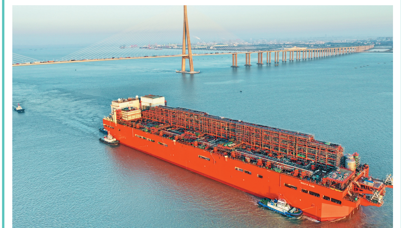
▲12月9日,大型浮式天然气液化装置“NGUYA FLNG”轮在拖轮拖带下,驶过苏通大桥(无人机照片)。当日,我国首座大型浮式天然气液化装置“NGUYA FLNG”轮从江苏南通开发区顺利拖航出江,前往浙江舟山进行上部模块安装、集成和调试。据了解,浮式天然气液化装置(FLNG)能够在深远海直接将开采出的天然气液化并储存,是海洋工程装备中建造复杂、附加值大的一类产品。
