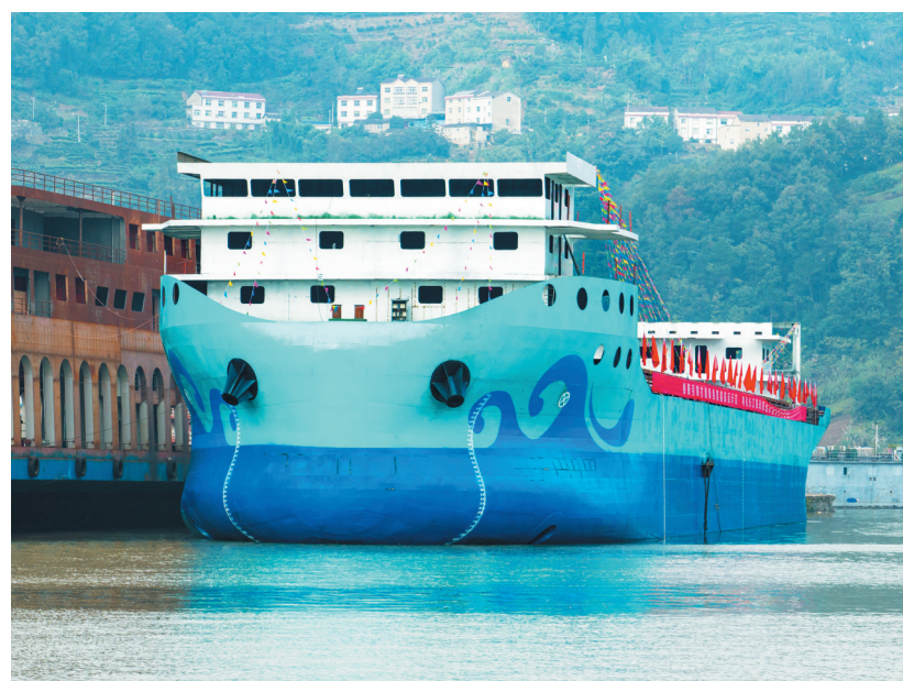
▲10月23日拍摄的“葛洲坝”号纯电动散货船(无人机照片)。10月23日,在湖北宜昌举行的2025绿色能源发展大会上,举办了我国目前最大的万吨级纯电动散货船下水及命名仪式,将其正式命名为“葛洲坝”号。该船也由此转入舾装阶段。据介绍,“葛洲坝”号纯电动散货船总长近130米,最大载重量超过1.3万吨。新华社记者 肖艺九 摄
