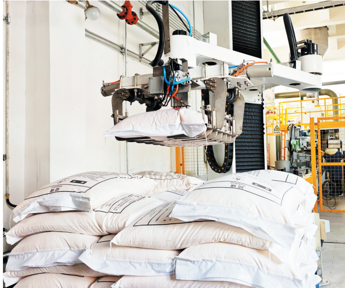
12月13日,在新疆新能源化工有限责任公司工业硫磺智能生产车间,机械臂精准抓取、码放工业硫磺成品。这一智能化生产模式可大幅提升生产效率,为企业高质量发展注入了科技动能。该公司以产品设计、生产执行为核心业务,覆盖8个业务领域,目前已打造出18个智能化应用场景。今年,该公司成功入选兵团5G智能工厂,推动生产经营不断向“智能制造”方向转型升级。 杜仪 朱小丽 摄
